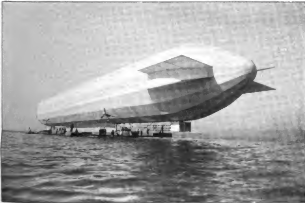
Das Luftschiff mit den Schwanzflossen zur Sicherung der Stabilität.
